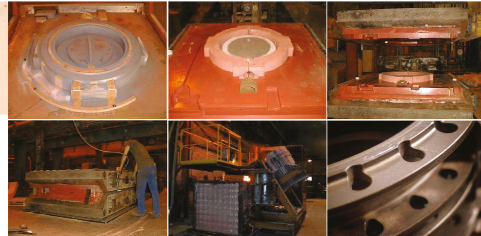
Chantier V-Process coulée verticale
